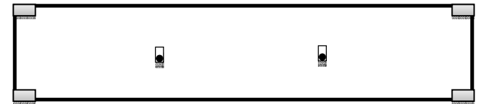
231 Placering af fødder og stillesko Placement of feet and set screws Platzierung von Füßen und Einstellschue
